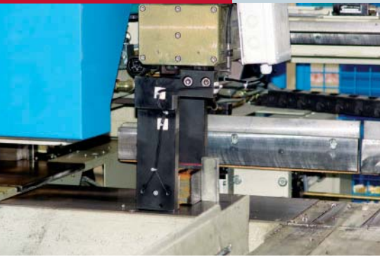
Detail: Eine der Sägemaschinen der Fertigungszelle, die automatisch mit Aufträgen und Halbzeug versorgt werden
